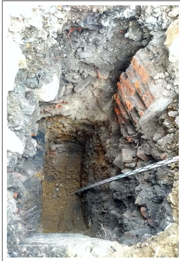
Abb. 1: Blick in Schürfgrube 4/17; Ziegelreste, Ziegel und eine Ziegelmauer, sowie Betonreste bis 2,5 m Tiefe. Darunter Echazkiese bis 4,0 m u. GOK.
