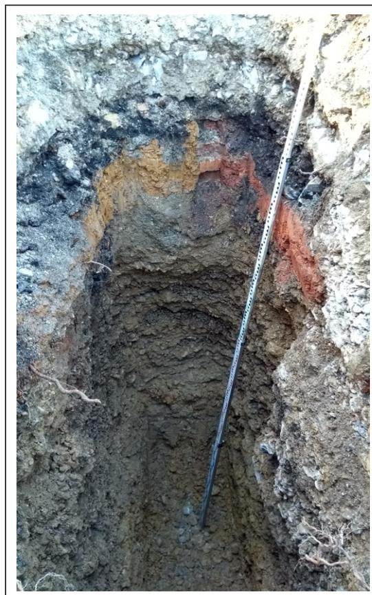
Abb. 2: Blick in Schürfgrube 6/17; Bis 0,6 m Schotter. Darunter bis 0,9 m schwarze Gießereischlacke mit Ziegel- und Betonblöcken (Fundamente). Bis 2,0 kiesige Auffüllung mit Betonresten, dann bis 3,4 m Echazkiese.
