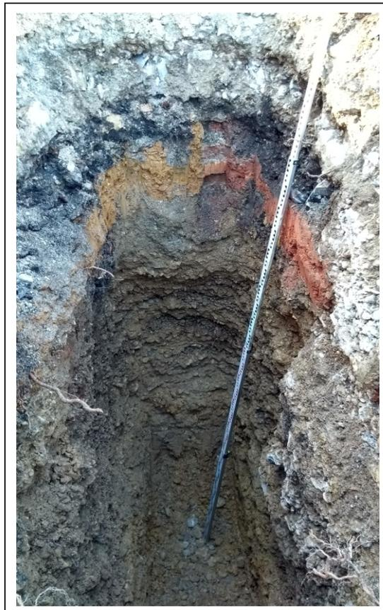
Abb. 4: Blick in Schürfgrube 6/17; Bis 0,6 m Schotter. Darunter bis 0,9 m schwarze Gießereischlacke mit Ziegel- und Betonblöcken (Fundamente). Bis 2,0 kiesige Auffüllung mit Betonresten, dann bis 3,4 m Echazkiese.
