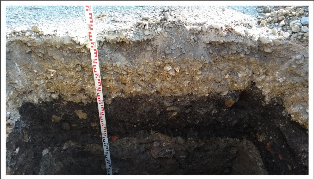
Abb. 1: Blick in Schürfgrube 1/17; Auffüllung bis 0,9 m u. GOK, im Bereich von 0,4 bis 0,9 m schwarz verfärbt. Darunter bindige Auffüllung mit kiesigen Anteilen bis 1,8 m.
