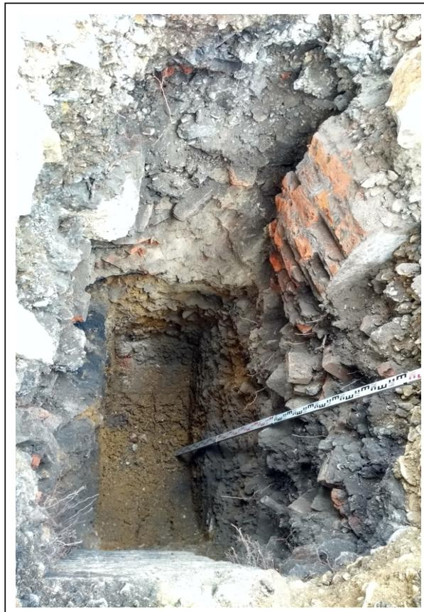
Abb. 2: Blick in Schürfgrube 4/17; Ziegelreste, Ziegel und eine Ziegelmauer, sowie Betonreste bis 2,5 m Tiefe. Darunter Echazkiese bis 4,0 m u. GOK.
