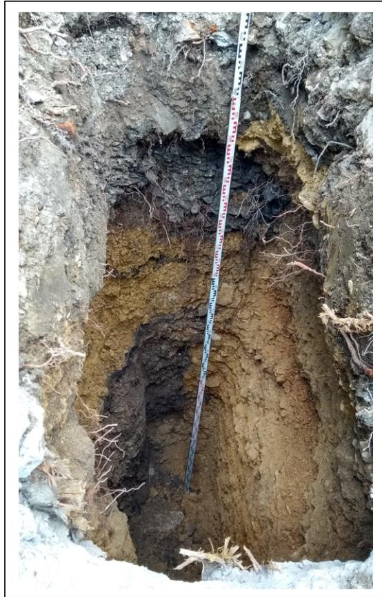
Abb. 3: Blick in Schürfgrube 5/17; Auffüllung bis 4,4 m mit Tonsteinstücken und Ziegelresten. Im Bereich 0 bis 0,6 m Betonreste (Fundament). Von 1,6 bis 2,0 m, sowie 3,0 bis 3,8 m schwarz verfärbte Bereiche.
