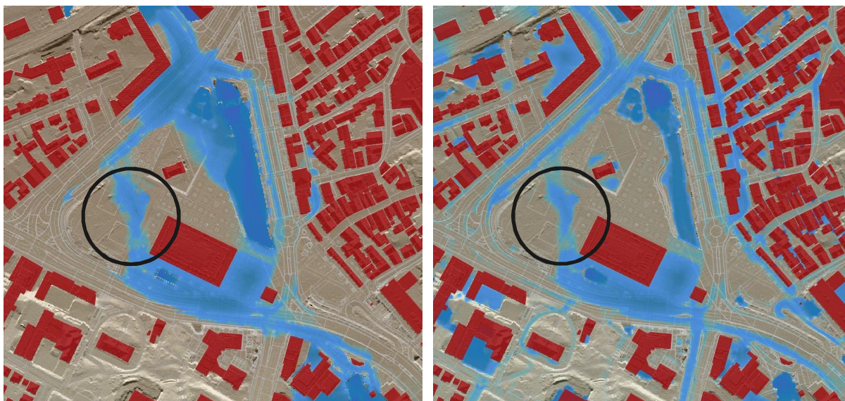
Abb. 2: Abflussmuster für HQ-Extrem (links) und für das simulierte Starkregenereignis (rechts)
