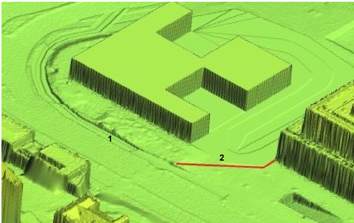
Abbildung 6: Straßenbegleitender Graben mit Leitwand
